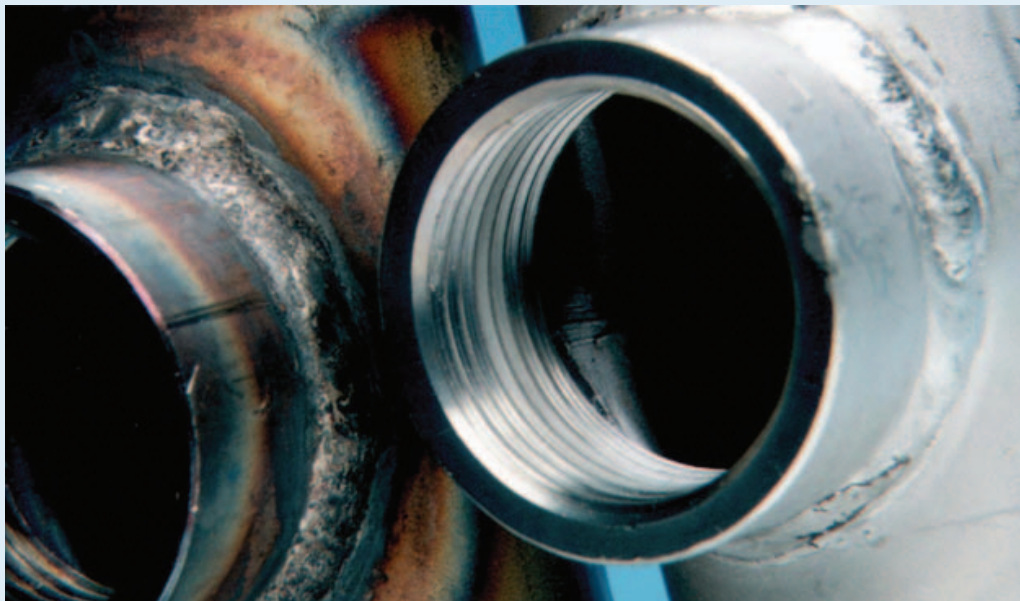
Schweißnaht vor und nach dem Beizen
