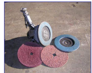
Druckluft-Rotor mit diversen Schleifscheiben
