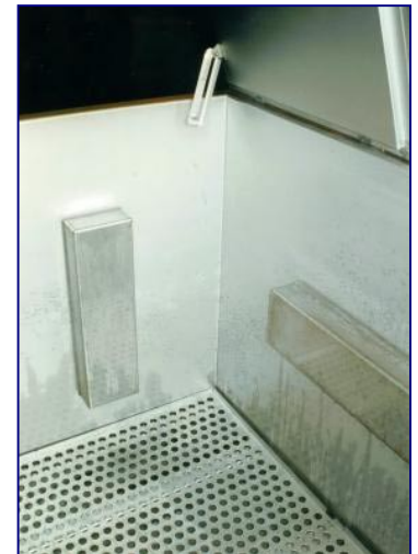
Ultrasoonbad mit an der Wand montierten Transducers
