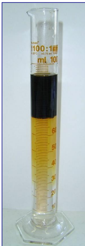
Foto 2: Trennung von Veclean LowCOD in eine Öl- und eine Wasserphase.
