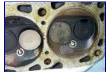
Gereinigtes Ventil Ungereinigtes Ventil
